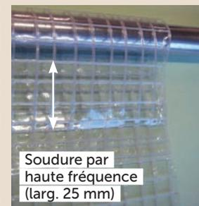
Soudure par haute fréquence (larg. 25 mm)
