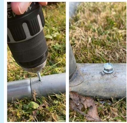
Assemblage des tubes par vis auto taraudeuses (outillage non fourni)
